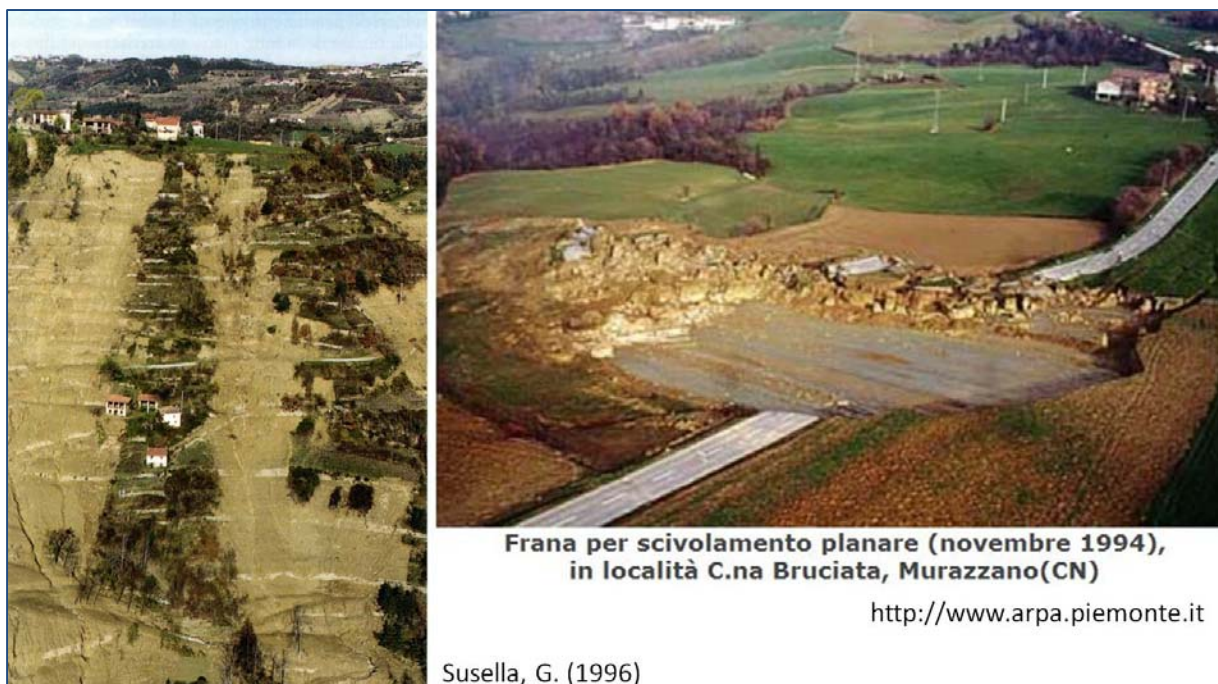
Abb. 23: Seichte „Soil slips“ an Hängen, die quer zur Schichtung liegen (links), Translationsrutschung an einem schichtparallelen Hang (rechts).
